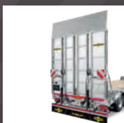
Rampe de încărcare pe întreaga lățime, acoperire cu plasă metalică.
