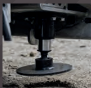
Picioare de sprijin hidraulice consolă spate
