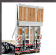
Rampe de încărcare pe întreaga lățime, acoperire cu lemn.
