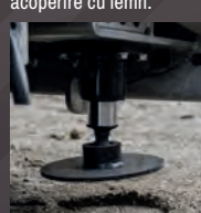
Picioare sprijin hidraulice în consola spate.
