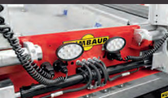
Translație laterală hidraulică a rampelor.
