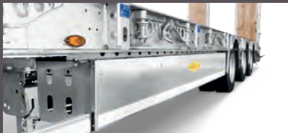
Ladă de depozitare pentru plăci de extensie laterală la 3 m.
