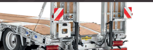
Rampe de încărcare simple, cu sistem hidraulic de acționare.
