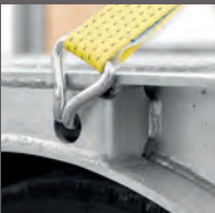
Puncte de ancorare integrate în cadrul lateral.
