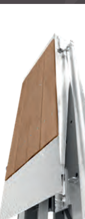
Rampe duble încărcare (unghi de acces de 8°).
