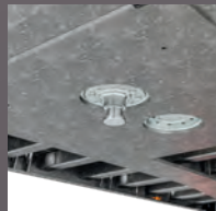
Cui cuplare demontabil, cu două poziții, pentru autotractoare cu 2 sau 3 axe
