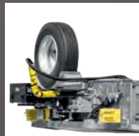
Suport pentru cablurile electrice și conductele pneumatice de alimentare.
