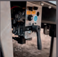
Suspensie pneumatică cu sistem de ridicare și coborâre.
