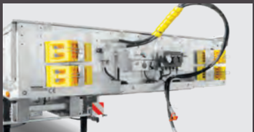
conexiuni pentru alimentarea pneumatică și electrică amplasate pe peretele frontal.
