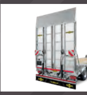
Rampe de încărcare pe întreaga lățime, acoperire cu plasă metalică.
